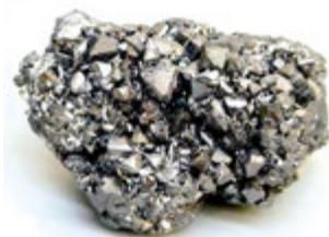
Рис. 8. Магнетит ( $\text{Fe}_3\text{O}_4$ ) как основа руды Старооскольского железорудного бассейна
